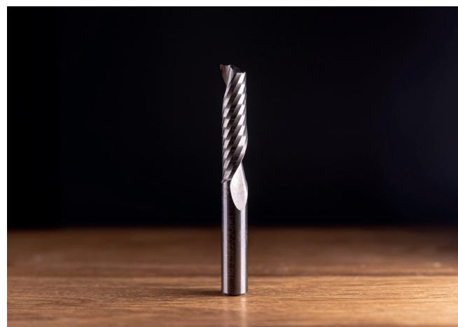
Важно учитывать направленность режущей кромки вверх - в процессе обработки фреза стремится оторвать материал от стола, поэтому необходимо обеспечить надежное закрепление заготовки. Конфигурация "стружка вверх" обеспечивает чистоту реза нижней кромки детали (со стороны стола), а на обратной поверхности возможно образование защиров или сколов.
